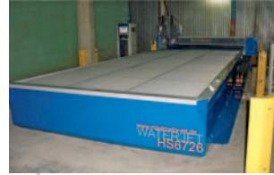
Vielseitig: HD-Anlage zum Trennen bis 6700 mm Länge
